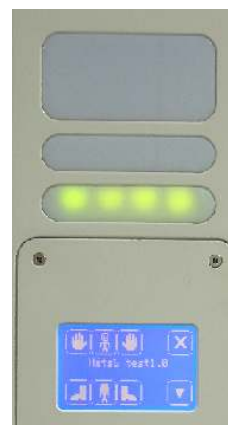
4. ábra. LED-sorok és érintőképernyős kijelző
