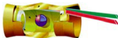
3. ábra. Zártcsatolású, nehéz ion indirekt gyújtású target koncepció (IFE tervezés, LLNL). A kapszula (hohlraum) hossza 20 mm és az átlagos átmérője ~5 mm. A központba helyezett fűtőelem gömböcske
