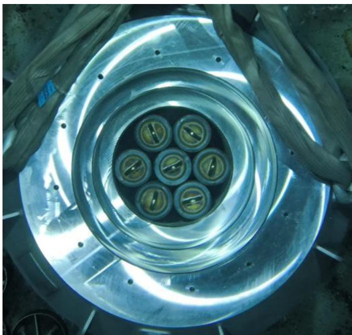
9. ábra. A konténerbe betárolt torpedók az Izotóp Intézet Kft. sugárforrás tároló medencéjében
