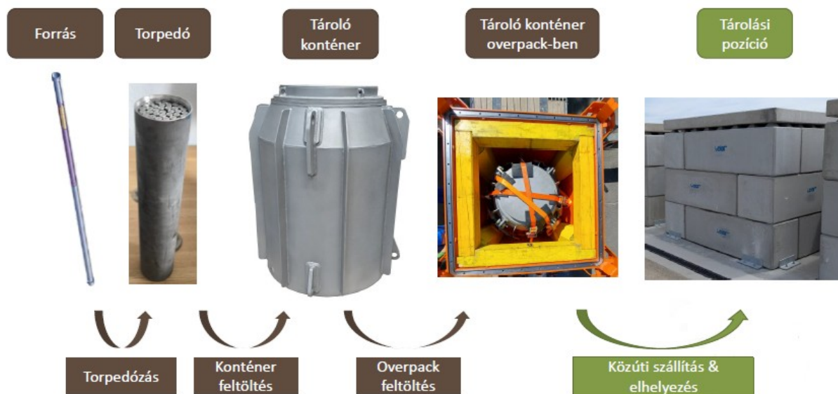
4. ábra. A konténeres sugárforrás-tároló rendszer koncepciója
