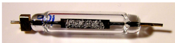
4. ábra. A magyar fejlesztésű búra dózismérő. (Fotó KFKI)
