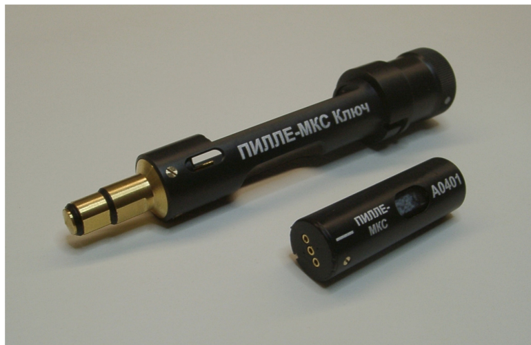
34. ábra. Az univerzális kiolvasó kulcs és az új típusú Pille dózismérő vékony falú tokozással. (Fotó KFKI)
