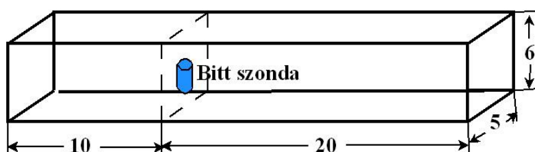
15. ábra. A térfogati integrálási határok értelmezése a szellőzőkémény Bitt szonda esetén. A méretek méterben vannak megadva, a Bitt szonda a szaggatott vonallal jelölt sík geometriai középpontjában van.
