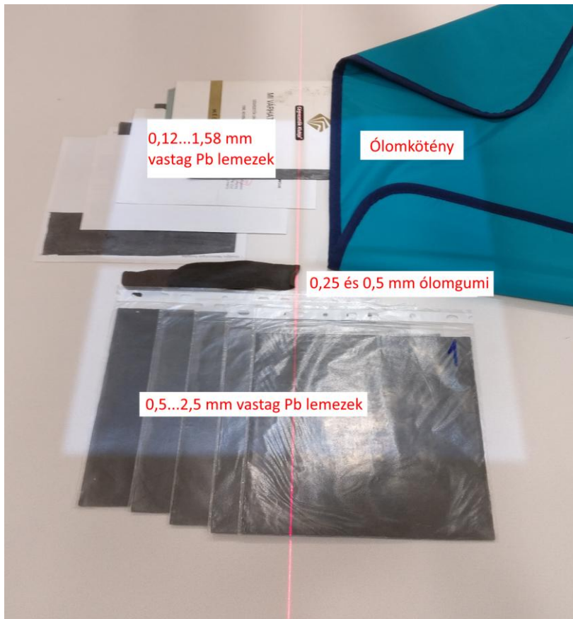
3a. ábra: Mérési elrendezésről készült fényképfelvétel
