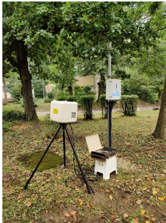
3. ábra: Az RSS-112 típusú ionizációs kamrával (balra) és a GM-szondával (jobbra) végzett párhuzamos méréseknél alkalmazott mérési elrendezés
