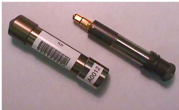
5. ábra. A Pille készülék dózismérője és a dózismérő védőtokja
