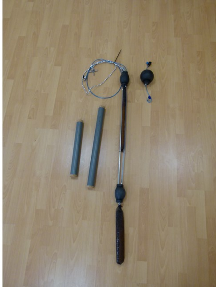
A háromfázisú zóna mintázására fejlesztett mintavevő
