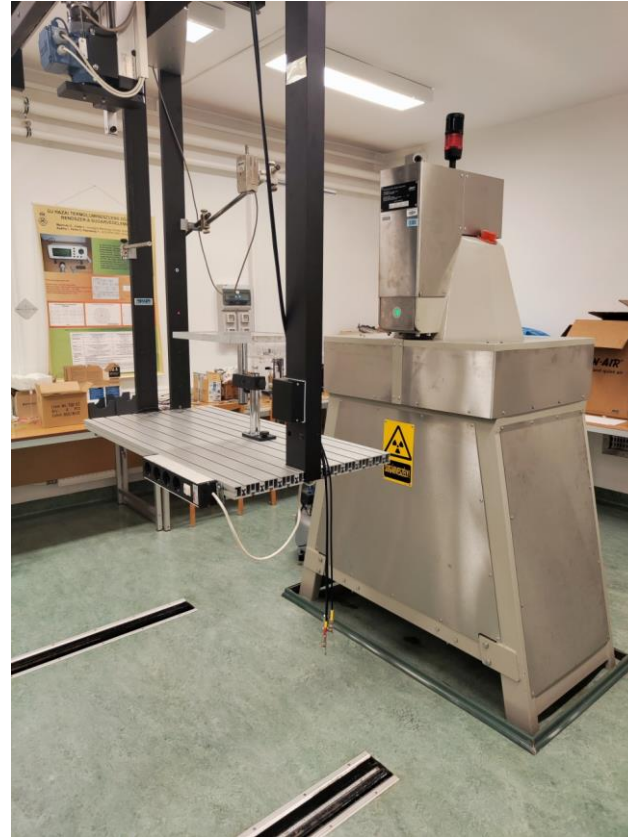
Műszerhitelesítő gamma- besugárzó - ^{137}\text{Cs} sugárforrással
